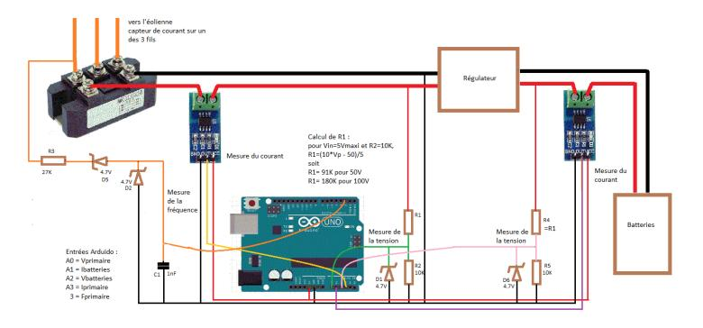
A noter : la sonde de courant Isortie est identique à Iprimaire. De même la sonde de tension Vsortie est de construction identique à celle pour Vprimaire : si jamais les batteries se coupaient, l'élévation de la tension sera mesurée sans risque de destruction de l'Arduino.
