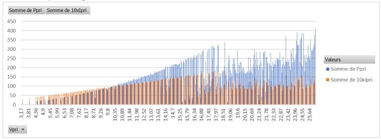
Etonnement le courant – et donc la puissance - chute d'un tier de sa valeur dès que la tension dépasse 18V.
