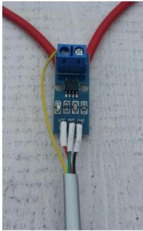
Mode de branchement des sondes de courant. La soudure est préférée à ce minuscule bornier. Le fil jaune recueille la tension.
